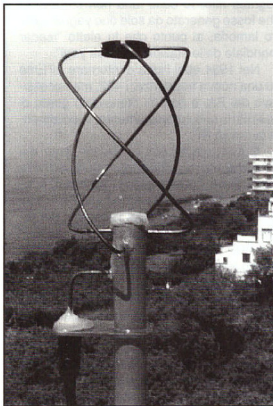
Foto 5 - L'antenna montata in opera, da cui si possono studiare tutti i dettagli costruttivi utili per la duplicazione. Le piccole dimensioni della quadrifilare per 435 MHz con guadagno di 5 dBic sono messe in evidenza dal paragone con le misure del suo connettore N in basso.
