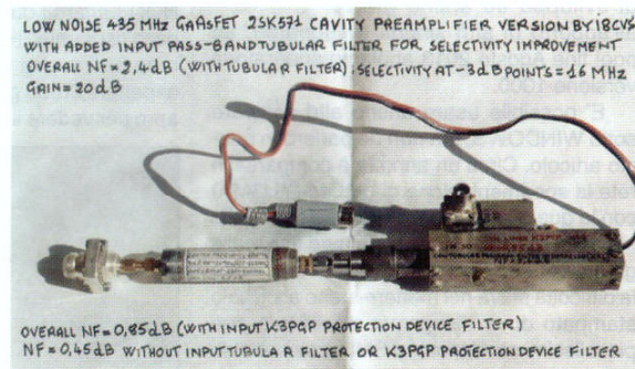
Foto 9 - Preamplificatore Low Noise in cavità per 435 MHz con filtro passa-banda tubolare in ingresso
