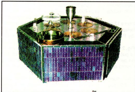
Foto 6 - P-3D con le antenne montate sulla faccia +Z e col motore di apogeo al centro. I pannelli solari sono chiusi per integrarlo nel vettore. Le antenne per le diverse bande sono descritte nel testo.
